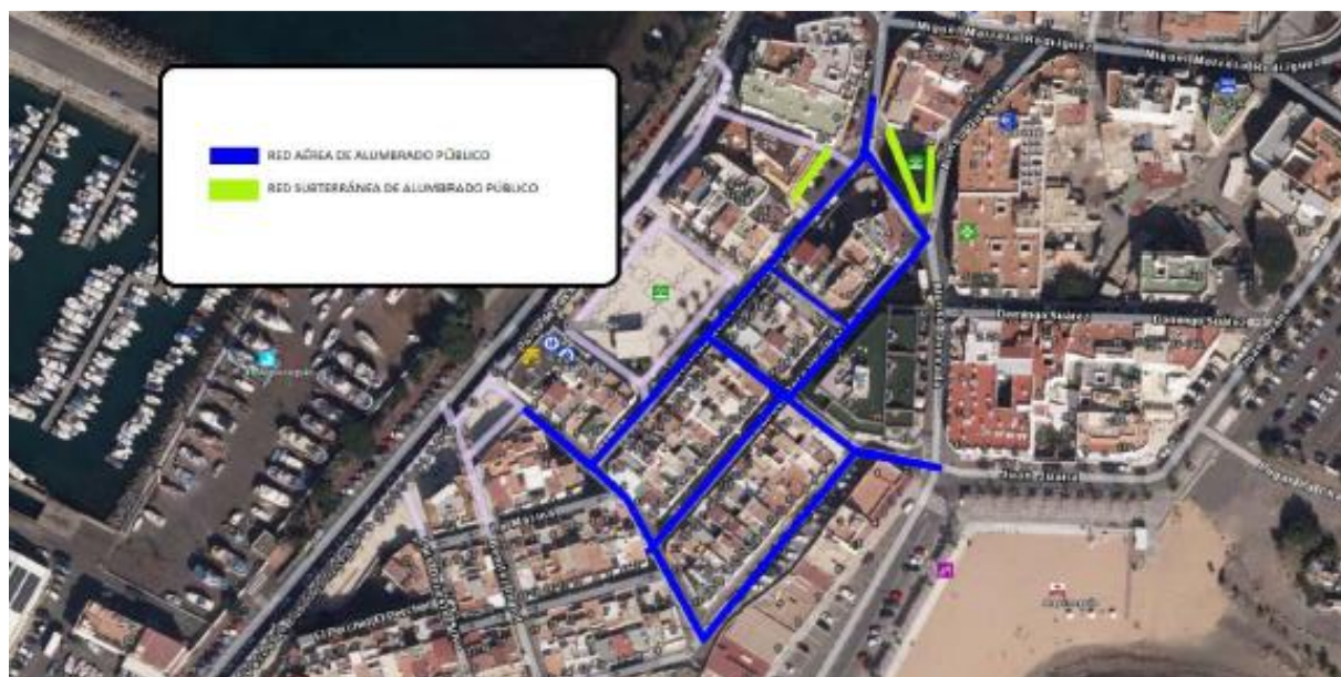
Esquema de la red de alumbrado público. FUENTE: Servicio de gestión de Servicios Públicos.
