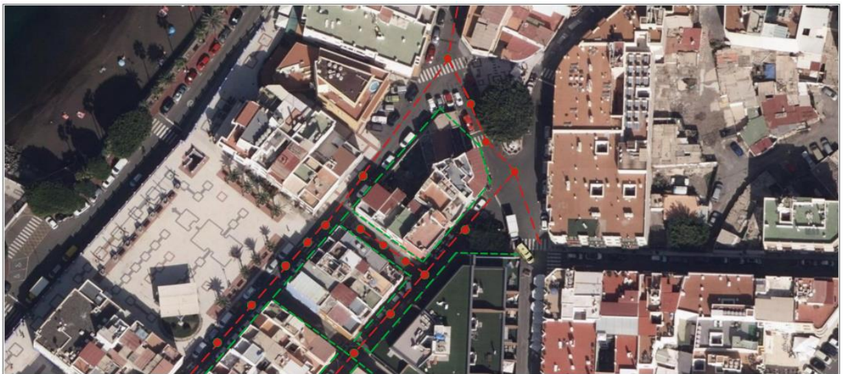
Esquema 1 de la red de saneamiento y abastecimiento. FUENTE: Servicio de gestión de Servicios Públicos.
